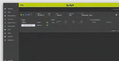
Über die Webschnittstelle des **FMS** (Fleet Management System) ist es möglich, den Status der AMR-Flotte einzusehen, eine Fernverbindung zu den einzelnen Robotern herzustellen, Aufgaben zuzuweisen, den Einsatzverlauf einzusehen, die beliebige Alarmzustände, bevorzugte und wiederholte Einsätze einstellen
