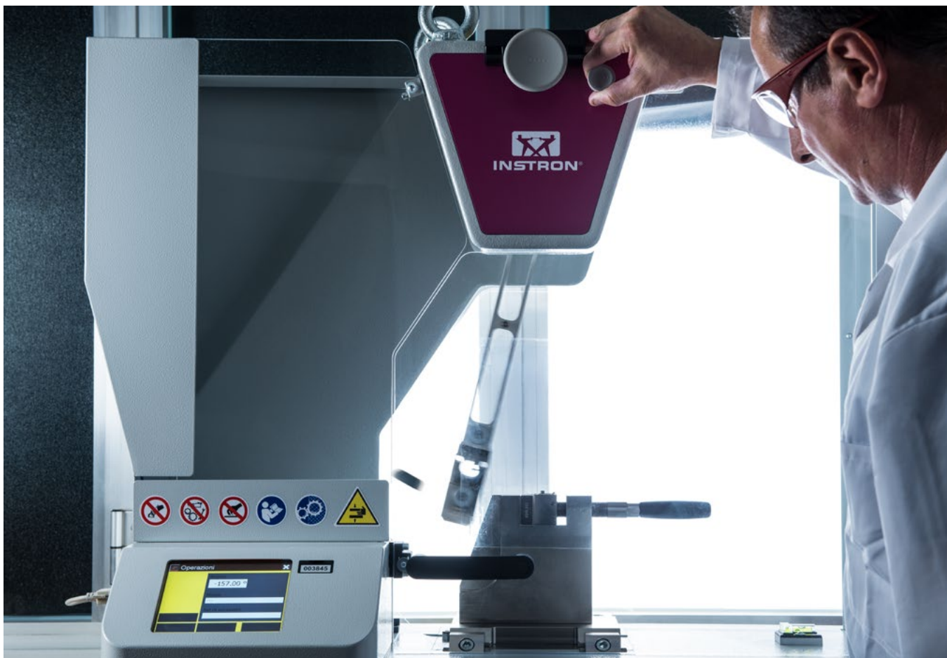
Prova d'impatto con pendolo.
