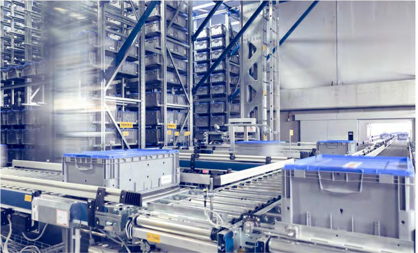
I 3 trasloelevatori movimentano 10.000 cassette Space iMiLOG 600x400 mm con altezza 220 e 18.000 con altezza 280 mm, portata 50 kg. Le cassette sono complete di barcode + RFID e logo a colori con processo IML In-Mould-Labelig.
