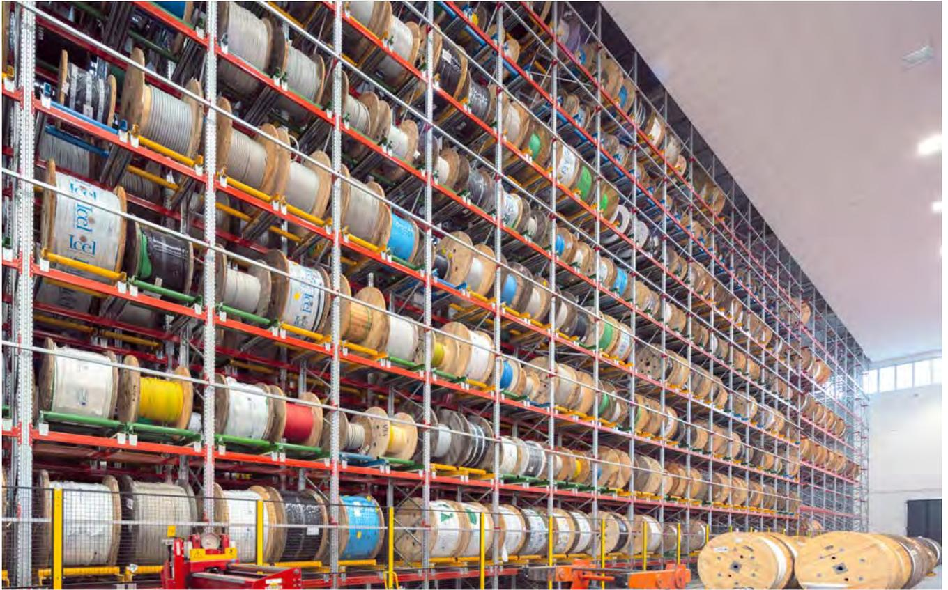
Magazzino automatico per bobine cavo con trasloelevatore a doppia profondità.
